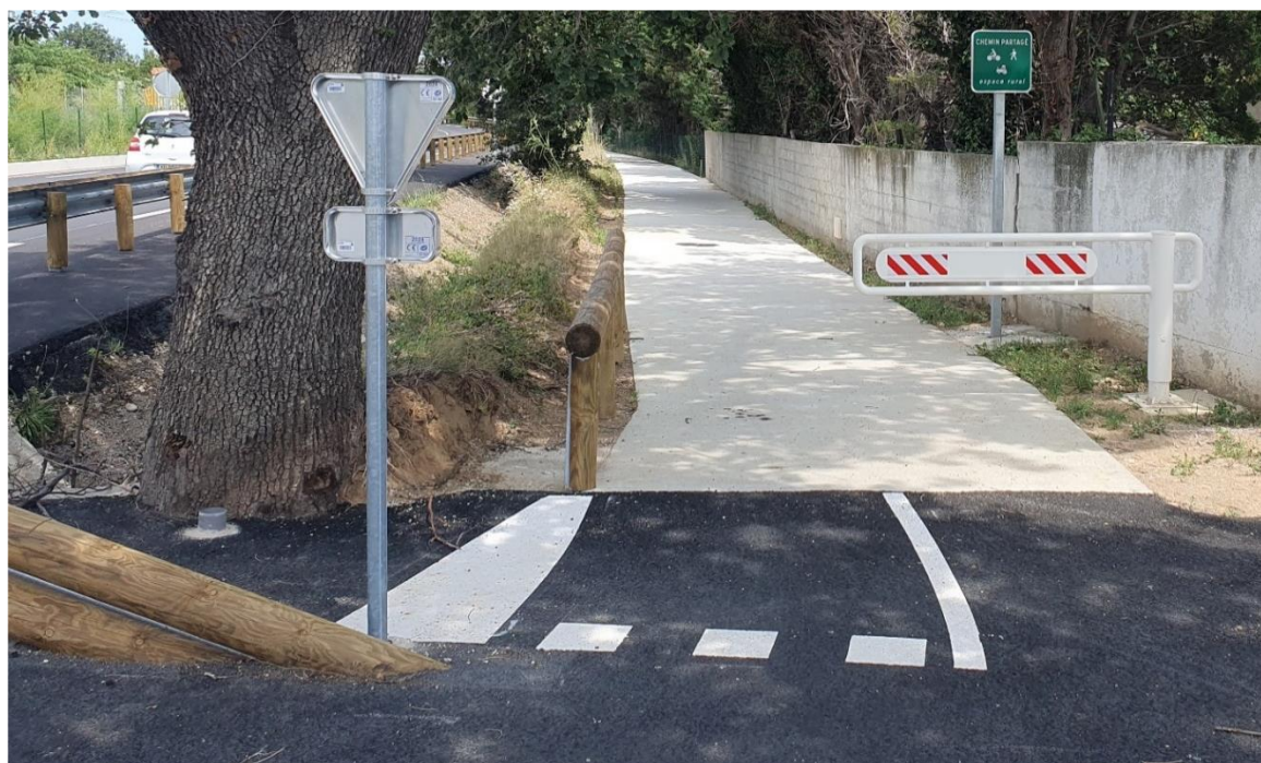
▲ Cette voie cyclable à Pollestres (D39) a les caractéristiques d'une voie verte : traitement des matériaux, obstacles aux véhicules motorisés (hors riverains), séparation de la chaussée routière. Cependant, la signalisation n'est pas adaptée, le panneau n'ayant aucune valeur réglementaire (AURCA, juillet 2024).
